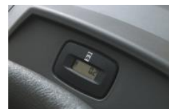
Compteur horaire avec rappel de maintenance
