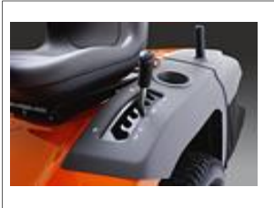
Levier de hauteur de coupe positionné sur l'aile
