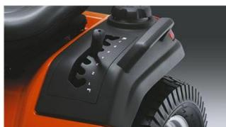
Ergonomiquement positionné sur l'aile. Il est assisté par ressort, ce qui permet de changer facilement et sans effort la hauteur de coupe.
