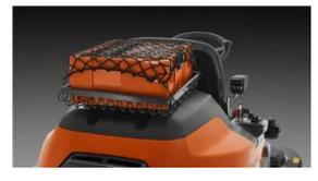
Ce modèle est équipé d'un rail pour installer un porte-outils pour des accessoires ou autres.
