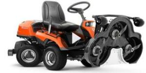
Plateau relevable à 90° pour en assurer l'entretien et le nettoyage.
